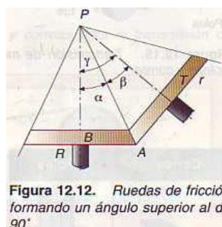
Figura 12.12. Ruedas de fricción formando un ángulo superior al de 90°.
