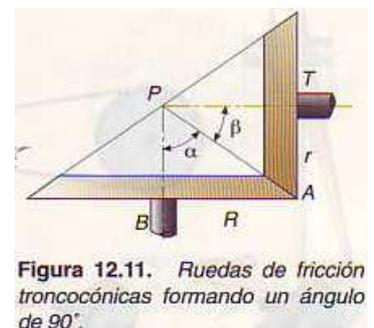
Figura 12.11. Ruedas de fricción troncocónicas formando un ángulo de 90°.
