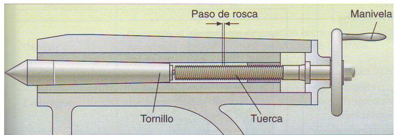
Fig. 13. Esquema del funcionamiento de la manivela con tornillo y tuerca.
