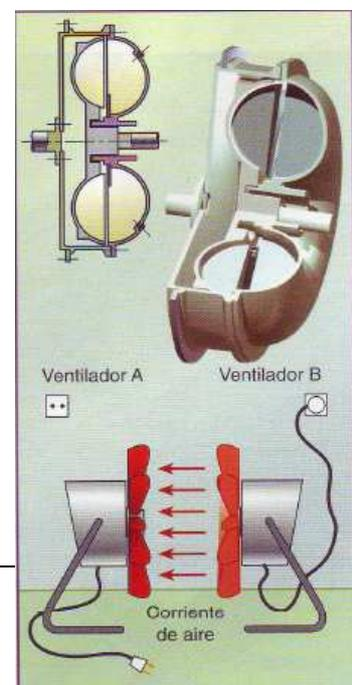
Fig. 5. Embrague hidráulico y principio de funcionamiento.
