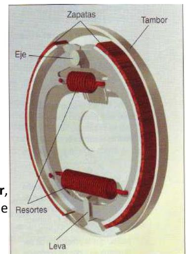
Fig. 7. Accionamiento mecánico de un freno de tambor.
