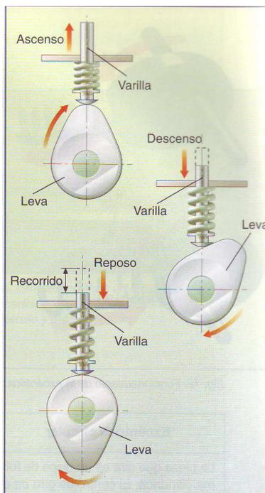
Fig. 11. Esquema del funcionamiento de la leva.
