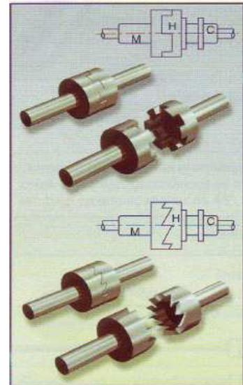
Fig. 4. Distintos modelos de embrague de dientes.
