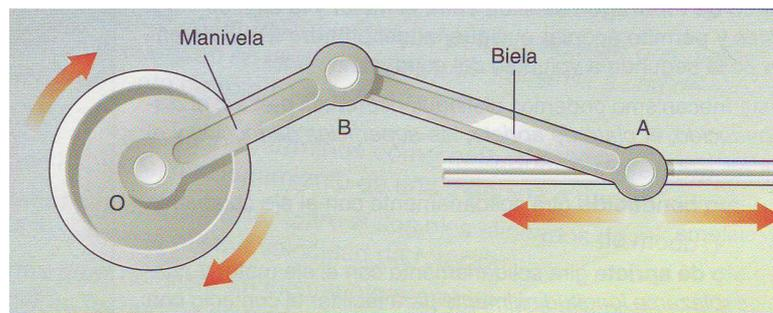
Fig. 6. Esquema del funcionamiento del mecanismo biela-manivela.
